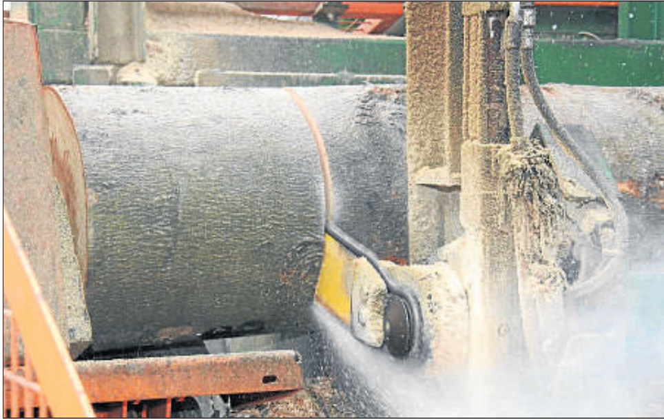
In der Sägespaltanlage werden die Baumstämme in Scheiben gesägt, ...
